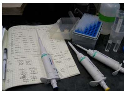
Tiene que ser un cuaderno **grande**, preferiblemente **encuadernado con tapa dura** (para resistir las duras condiciones del laboratorio), **con trama** (cuadrículado o milimetrado), para que sea más fácil dibujar gráficos o hacer tablas, y con las **páginas numeradas** (así sabrás enseguida si falta alguna página). Se recomienda:
